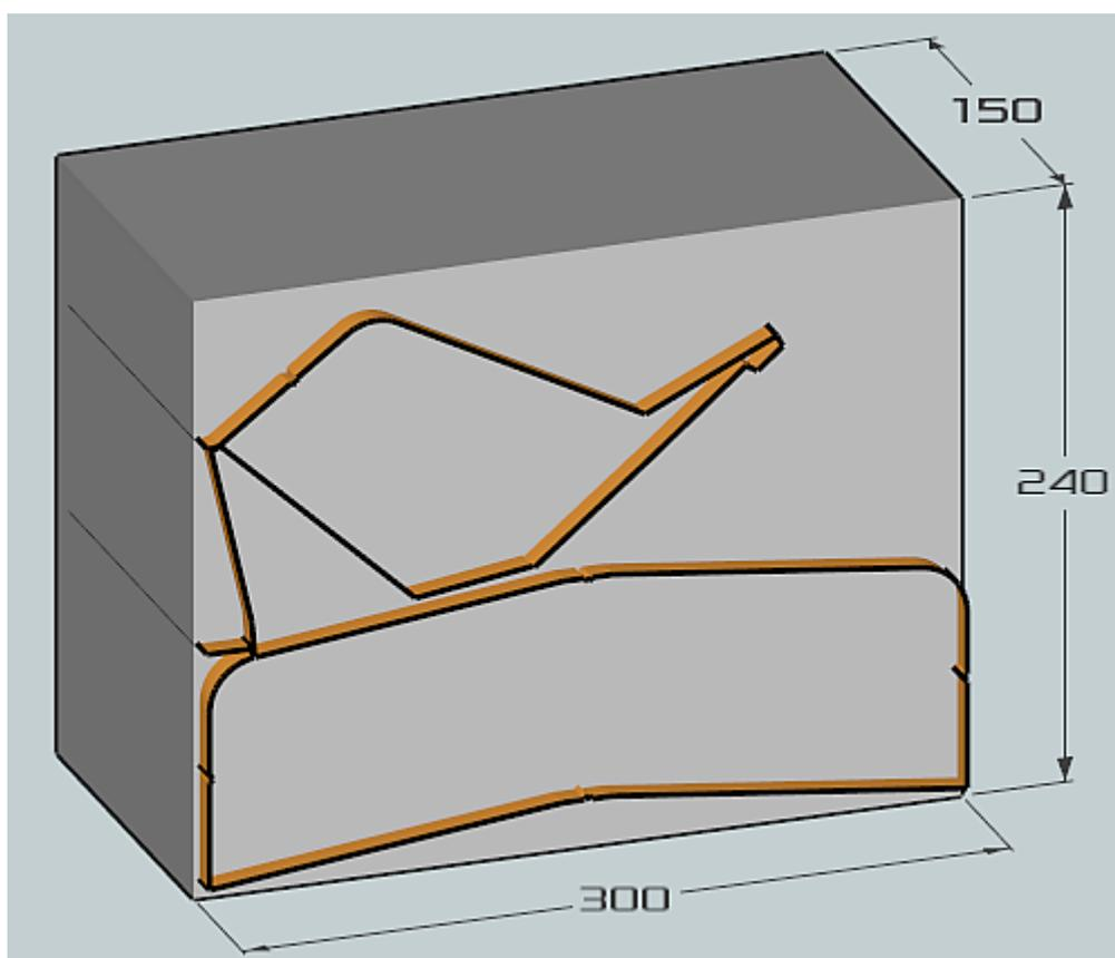
Enlever la dépouille, séparer les deux pièces et découper pour chaque pièce les vues de côté **sans décaler le fil pour obtenir 15 épaisseurs de 8mm** (les aller-retour sont séparés de 9mm, et la saignée du fil est généralement de l'ordre de 1mm). L'outil d'étirement peut être utilisé dans MiniCut2d Software pour augmenter l'écart entre les passes si le besoin s'en fait sentir.
