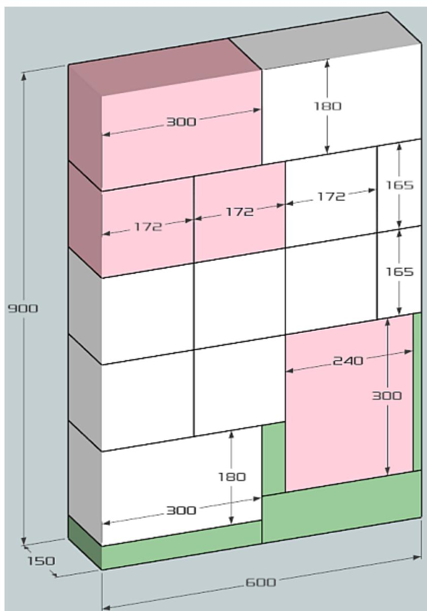
Les blocs représentés en rose correspondent au minimum à préparer. Cela permet d'obtenir deux avions complet. Les blocs verts correspondent aux chutes. La grosse chute en bas à droite peut être recoupée en deux pour réaliser un 10<sup>ème</sup> EPProof.
