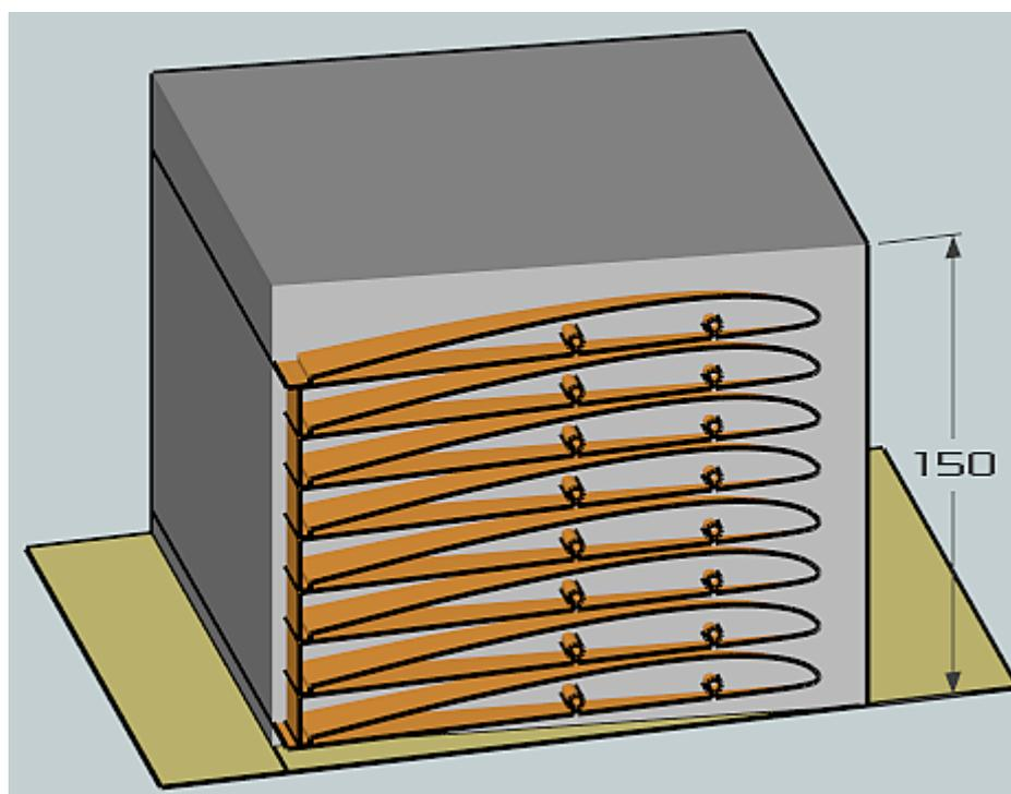
Disposer ensuite le deuxième bloc **de façon symétrique** sur la plateau de la MiniCut2d et répéter la découpe des profils d'ailes. **Attention, il faut obtenir des ailes qui seront des miroirs de celles de la découpe précédente, sinon vous n'aurez que l'aile gauche de l'EPProof et pas l'aile droite !**
