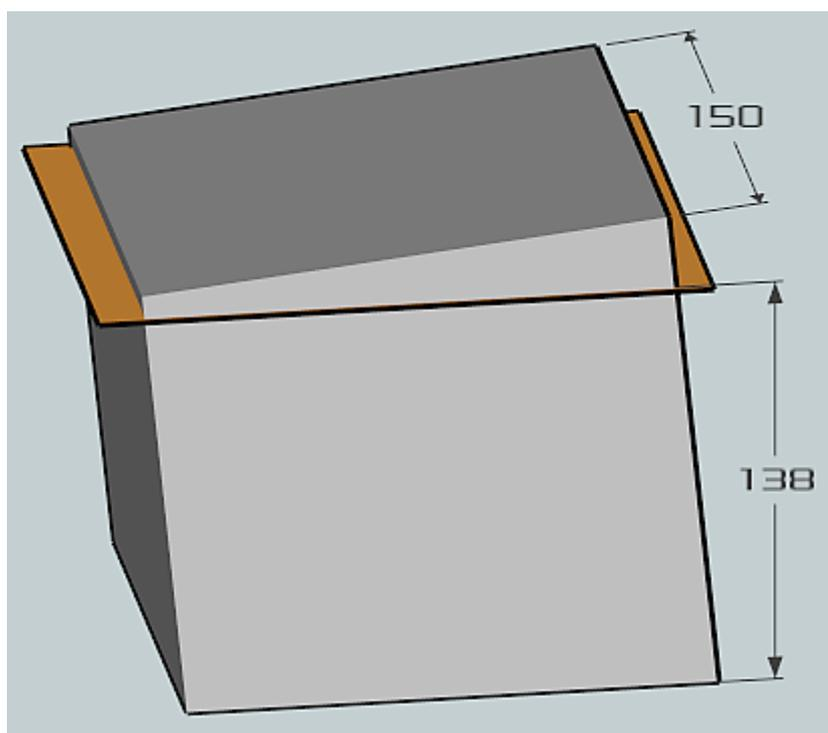
Prendre un des deux blocs, le faire basculer et découper les profils d'aile dans l'épaisseur de 150mm. Attention, le bord du bloc n'est pas parallèle au plateau de la MiniCut2d :
