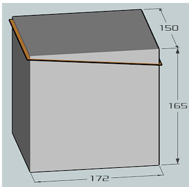
Retourner ensuite le bloc sur le plateau et faire une guillotine horizontale en manuel à 138mm au-dessus du plateau (utiliser un régleur pour mesurer la hauteur du fil), préparer ainsi les deux blocs.
