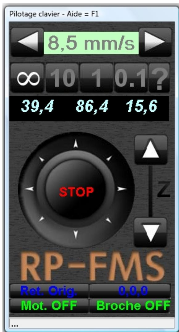
Cette fen  tre sert    commander les d  placements manuels de la fraise,    stopper les d  placements en cours,    mettre en marche ou arr  ter les moteurs et la broche.
