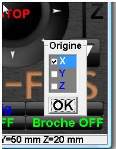
Lorsqu'on appuie sur ce bouton, une fenêtre permet de choisir quel(s) axe(s) remettre à zéro. Il faut valider par OK.
