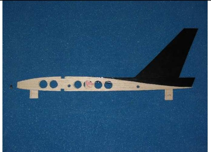
Installation de l'assemblage formé par les pièces n6, d1 et n7 sur les tubes carbone.
