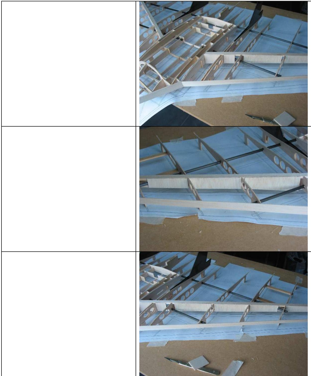
Coffrage intégral de l'extrados de l'aile en balsa 1,5mm.
