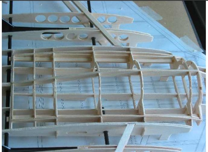
Mise en place du faux bord d'attaque en balsa 1,5 mm.
