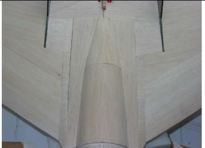
Mise en place du bord d'attaque en balsa 8 mm sur la partie centrale. Il sera mis en forme par ponçage.
