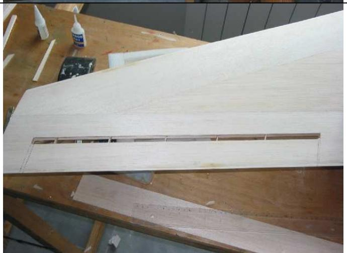
Ajout du flanc balsa 5 mm sur l'aileron avant découpe des cotés. Ceci permet de limiter le vrillage de l'aileron.
