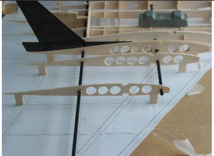
Mise en place des nervures n10 et n11.
