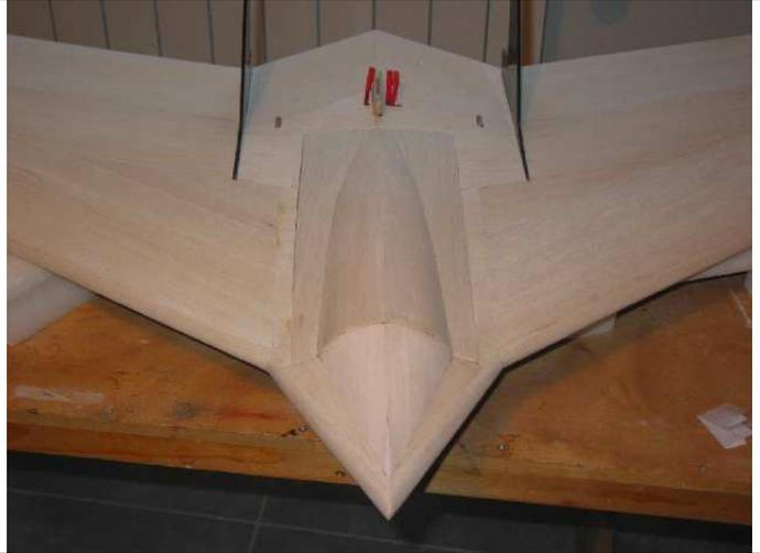
Tracé de la zone de découpe des ailerons sur la partie supérieure.
