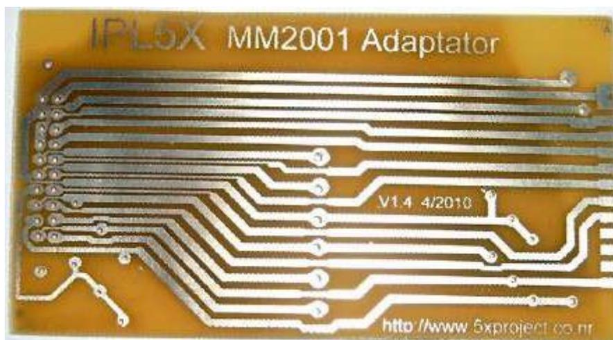
Côté IPL5X, le connecteur HE10-20, côté MM2001 un connecteur SubD25 et un bornier pour pouvoir raccorder des fins de courses et autres éléments annexes...
