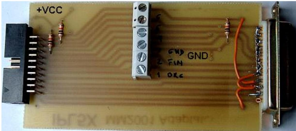
Il est prévu également sur l'adaptateur, la possibilité d'installer trois résistances de « tirage » des signaux soit vers le GND soit vers le +VCC suivant l'électronique qui se trouve en aval (cf. photo ci-dessus : deux résistance de tirage vers +VCC et une vers GND).
